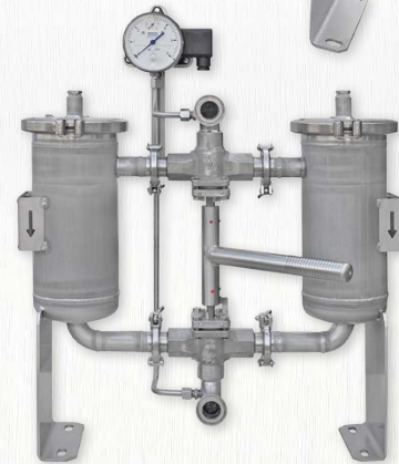
Doppelfilter, Variante mit Topfschmutzfänger umschaltbar über 3-Wege-Kugelhähne DN25 Filterreinigung ohne Werkzeug
